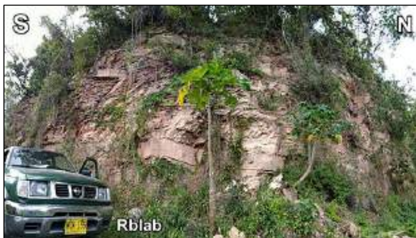
Gráfica 51. Roca blanda intercalaciones de lodolitas y areniscas de la formación Barco (Rblab). . N: 1.380, 053 E: 849, 824 Z: 725 m.s.n.m. Ubicación: Desvió de la mina del Presidente
