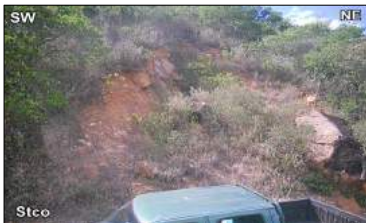
Gráfica 68. Suelo transportado coluvial (Stco). N: 1.360, 131 E: 841, 216 Z: 470 m.s.n.m. Ubicación: Vía hacienda Carrillo
