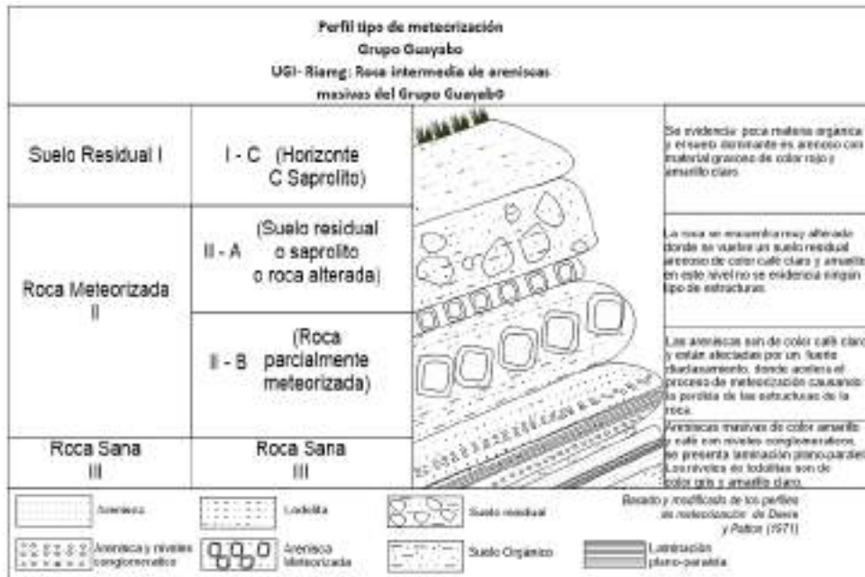
Gráfica 27. Perfil tipo de meteorización de areniscas masivas del Grupo Guayabo.
