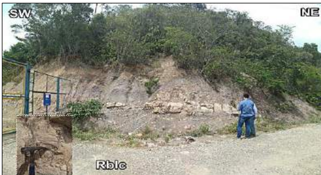
Gráfica 54. Roca blanda de lodolitas de la formación Cuervos (Rblc). N: 1.379, 995 E: 849, 957 Z: 766 m.s.n.m. Ubicación: En la Mina vereda Paso de dos Ríos
