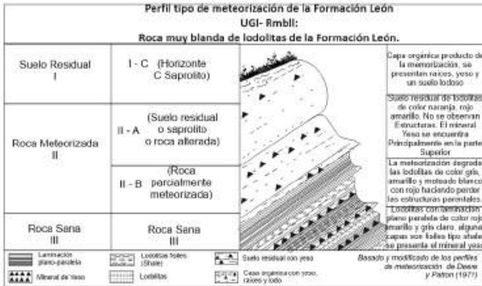
Gráfica 23. Perfil tipo de meteorización para lodolitas de la Formación León
