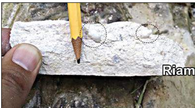
Gráfica 34. Roca intermedia de areniscas de la Formación Mirador (Riam) donde se observan conglomerados. N: 1.409, 586,567, E: 839.931,988, Z: 142.24 m.s.n.m. Ubicación: Barranca - vía las minas de Carbón.
