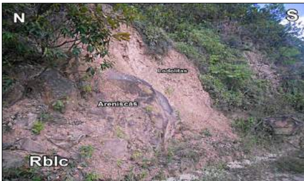
Gráfica 53. Roca blanda de lodolitas de la Formación Cuervos (Rblc). N: 1.380, 888 E: 854, 923 Z: 485 m.s.n.m. Ubicación: vía Arrayan
