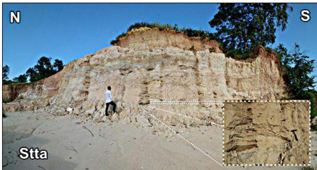
Gráfica 41. Suelo transportado de terraza aluvial (Stta). N: 1.416, 471, E: 845.766, Z: 61 m.s.n.m. Ubicación: Casco urbano Banco Arena.
