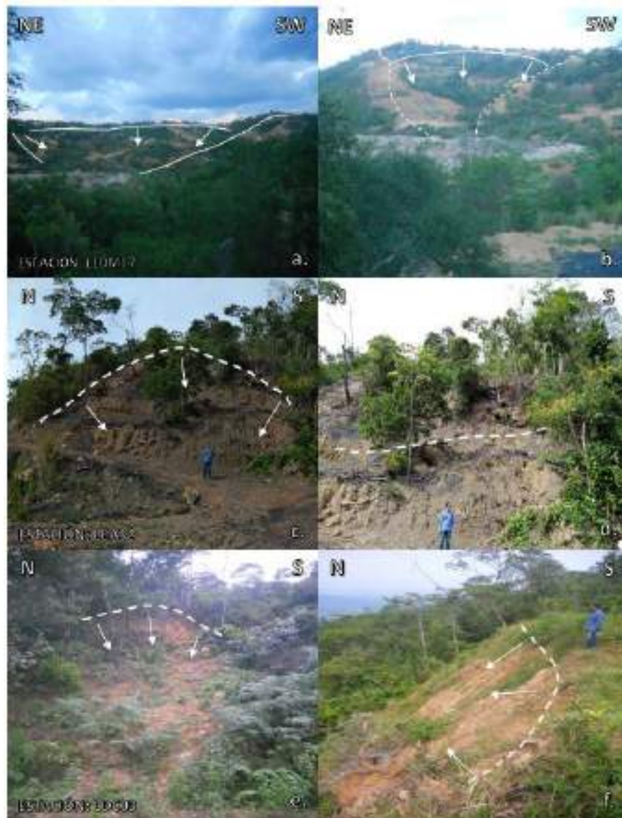
Gráfica 139. Deslizamientos traslacionales en la zona rural del municipio de San José de Cúcuta. A y b hacen parte de la estación LEDM17. Coordenadas: N=1.367.470,835 m, E=836.965,462 m. C y d hacen parte de la estación LEA32, Coordenadas: N= 1.378.068 m, E= 851.180 m. E y f hacen parte de la estación LDC03, coordenadas: N= 1.380.164 m, E= 857.922 m
