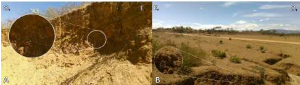
Gráfica 47 Roca muy blanda de lodolitas de León para la zona de expansión urbana. A. Coordenadas: E 841.349 m, N 1.371.478 m. B: E 840.592 m, N 1.371.994 m
