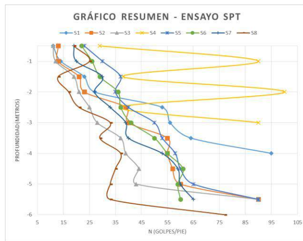
Gráfica 127. Grafica Resumen N (golpes/pie) – ensayo SPT percusión
