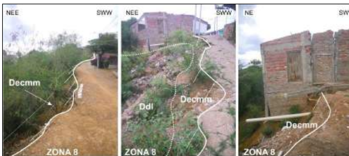
Gráfica 166. Escarpe de corona principal de movimiento en masa (Decmm).
