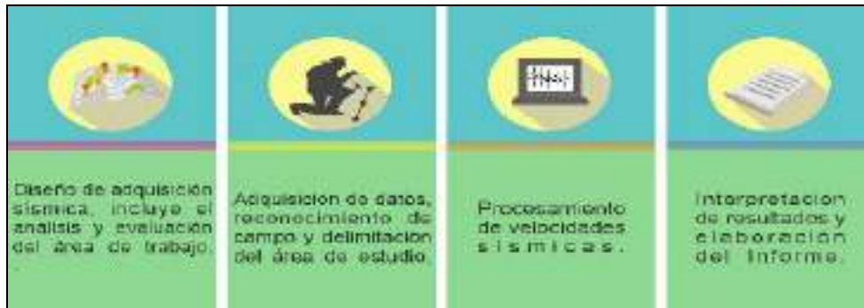
Gráfica 99: METODOLOGÍA PARA EXPLORACIÓN DEL SUBSUELO MEDIANTE EL MÉTODO DE REFRACCIÓN
