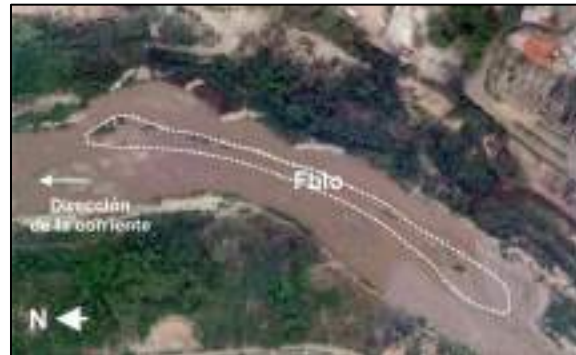
Gráfica 149. Barra longitudinal en el cauce del río Pamplonita.
