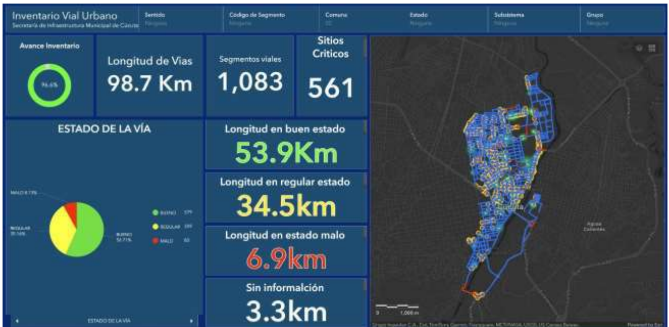
Ilustración 19 Estado de malla vial comuna 2
